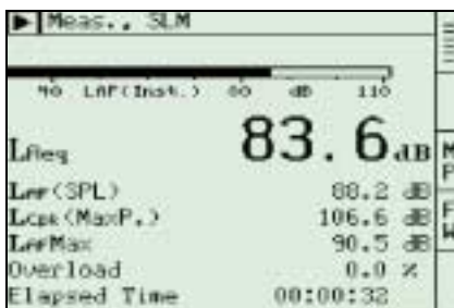
Fig. 8 Schermo Multi-D che mostra il display simultaneo ed in tempo reale dei parametri in banda larga e del tempo trascorso
